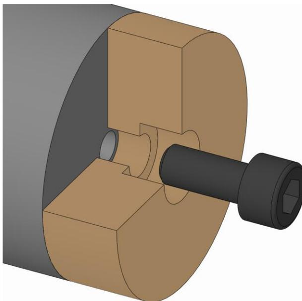
1. Allentare la vite di fissaggio della parte intercambiabile e rimuoverla.
