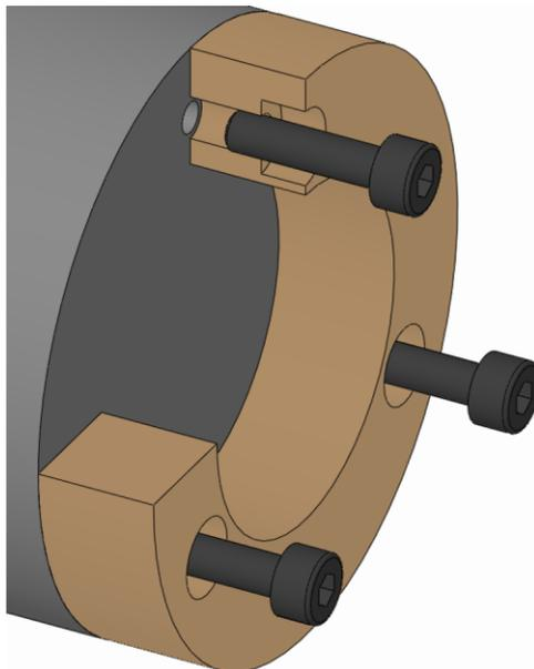
1. Allentare le viti di fissaggio della parte intercambiabile e rimuoverle.
