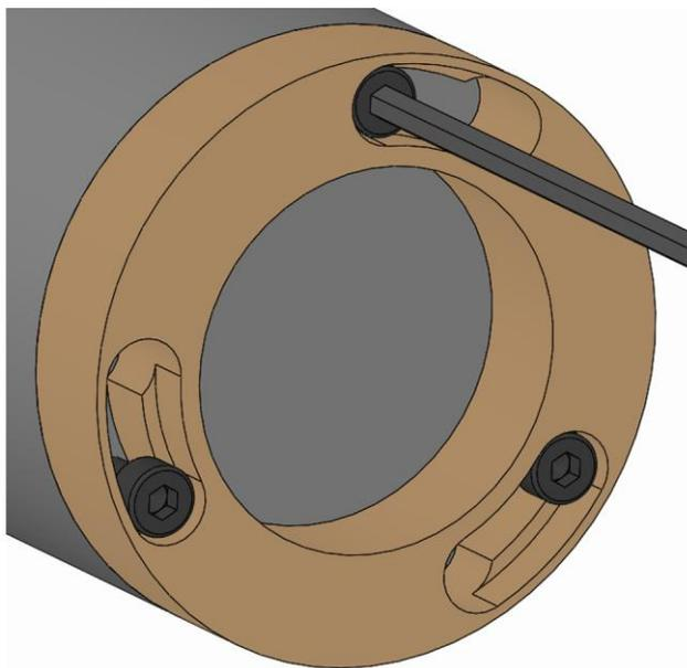
1. Allentare di qualche giro le viti di fissaggio della parte intercambiabile senza rimuoverle.
