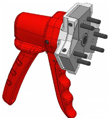
Le spine dell'attrezzo per cambio pinze vengono introdotte nei fori per il cambio nella pinza di serraggio. L'attrezzo per cambio pinze viene azionato a mano. A seconda della grandezza, l'attrezzo per cambio pinze è concepito per l'azionamento a una o due mani. La pinza di serraggio è bloccata nell'attrezzo per cambio pinze, per mezzo del quale può essere introdotta nel mezzo di serraggio montato.
