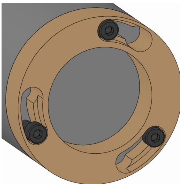
2. Ruotare la parte intercambiabile in modo che la testa della vite di fissaggio della parte intercambiabile entri nell'apertura a baionetta.
