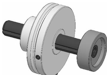
Le battute di appoggio vario quick funzionano con una filettatura trapezoidale precisa che permette di regolare rapidamente la profondità mandrino.
