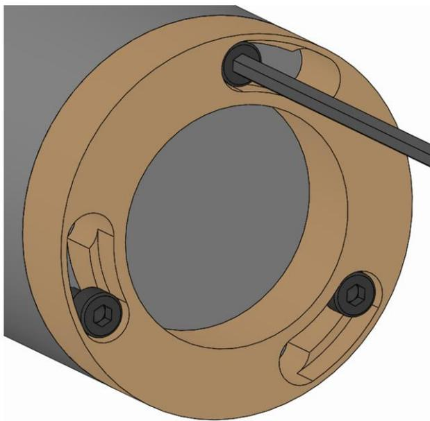
3. Serrare le viti di fissaggio della parte intercambiabile con la coppia prescritta [vedi capitolo »Coppie di serraggio delle viti«].
