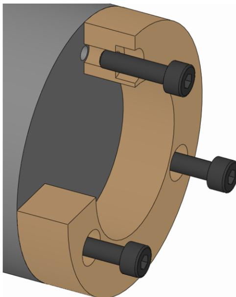
2. Avvitare le viti di fissaggio della parte intercambiabile e serrarle con la coppia prescritta [vedi capitolo »Coppie di serraggio delle viti«].
