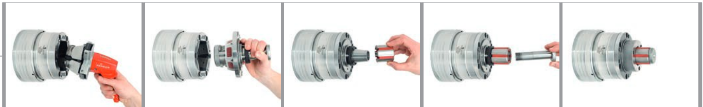
Rimuovere la pinza di serraggio e la battuta pezzo
